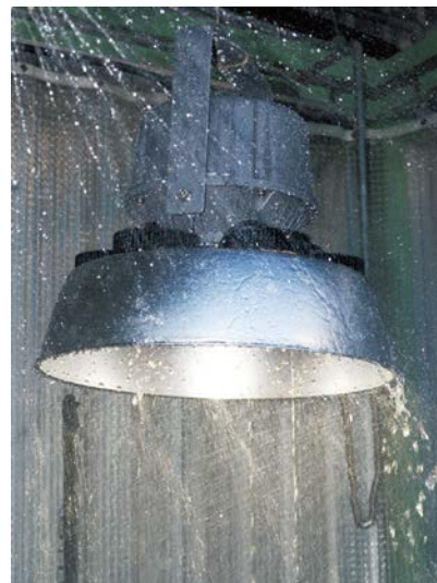
防水試験の様子
